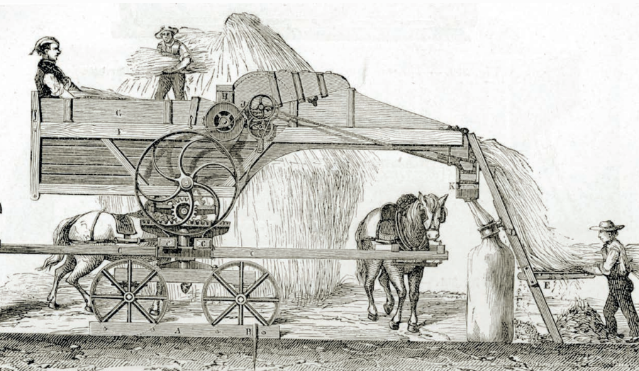
Zeichnung einer Dreschmaschine mit eingebautem Göpel aus einem technischen Lexikon des Jahres 1881
