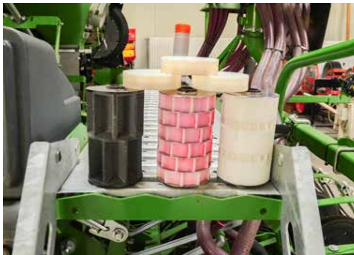
Die richtige Dosiereinheit für das jeweilige Saatgut reduziert den Kornbruch.
