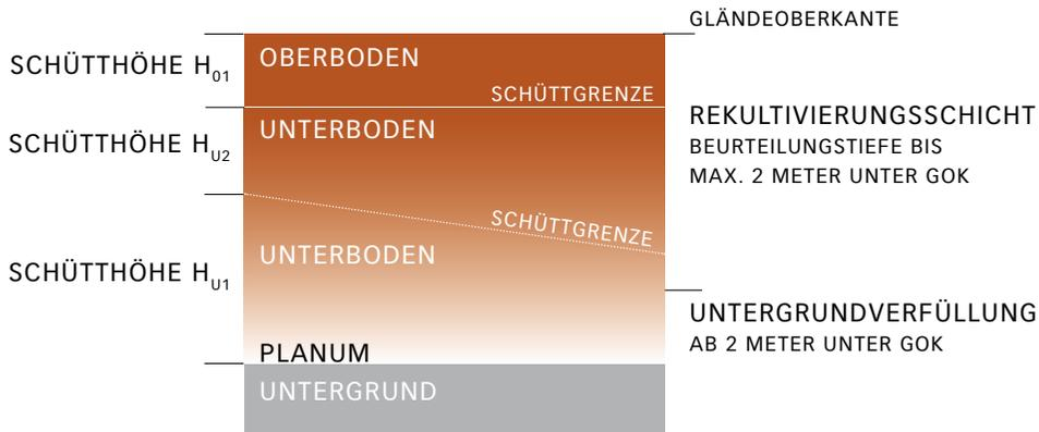
Der Aufbau erfolgt schichtenweise und hat sich an Böden der Region mit vergleichbarer Funktion zu orientieren. Ein abgestufter, nach unten abnehmender Gehalt an organischer Substanz und an Nährstoffen ist einzuhalten. Die Schichtübergänge zum Planum und zu den Schüttgrenzen sind möglichst zu verzahnen. Schadverdichtungen sind zu vermeiden bzw. während des Einbaues verursachte Schadverdichtungen sind zu beseitigen (siehe Kapitel 5 „Mängelbehebung“).
