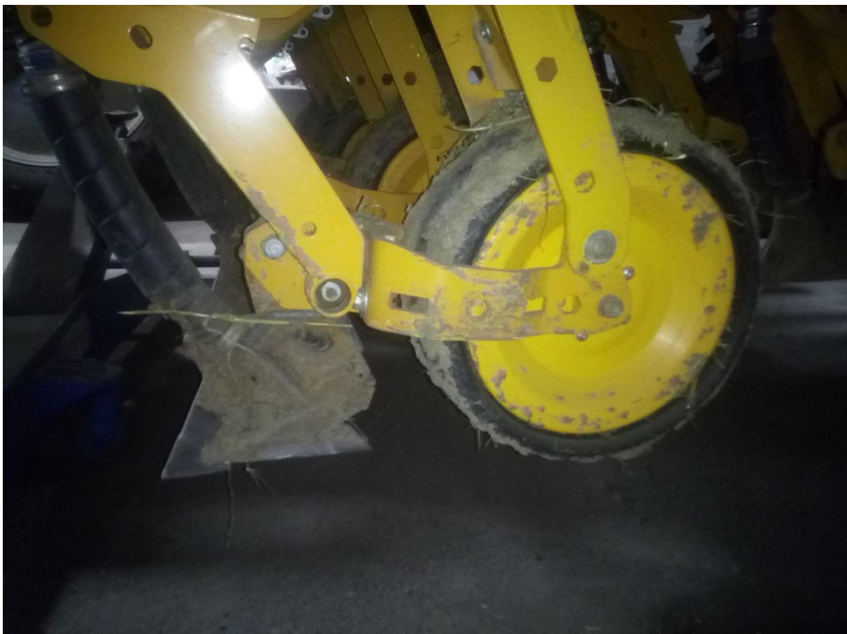
Schmales Säsaat mit Tiefenführungsrolle
