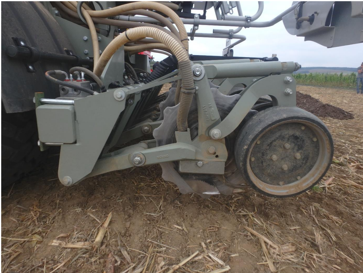
Säelement mit Säscheibe, Säschuhen und Andruckrollen
