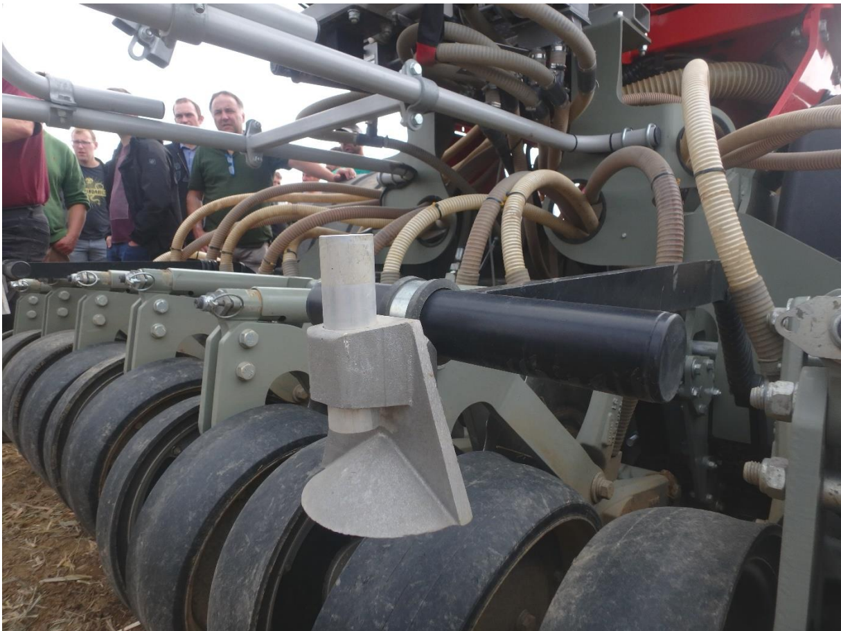
Prallteller für Breitsaat (ohne Zulaufschläuche)
