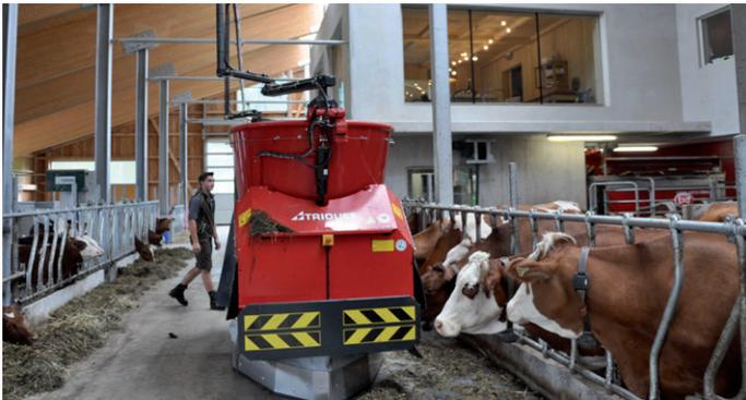
**DER TRIOLIET** fährt auch problemlos auf breiten Futtertischen (vier Räder, zwei gesondert angetriebene Räder (Panzerlenkung)). Der Roboter hat zwei vertikale Mischschnecken und ein beidseitig austragendes Querförderband.
