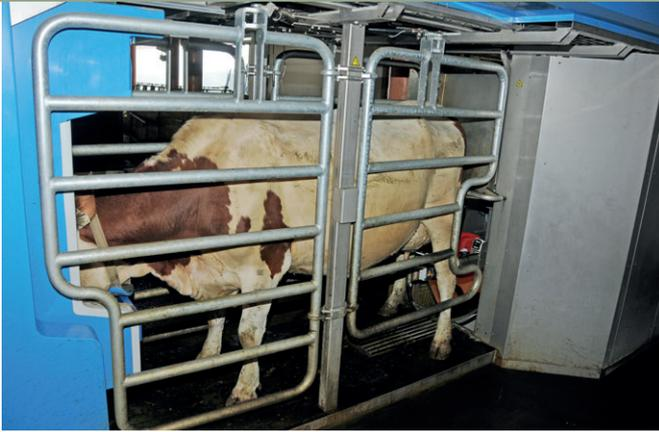
**DER ROBOTER** melkt die Tiere von hinten. Je nach Tiergröße wird der Kraftfuttermagazin nach dem Betreten des Roboters nach hinten verschoben und so die Kuh in eine optimale Position gedrängt.
