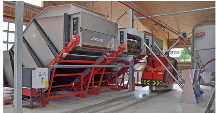
**DREI VORRATSBUNKER** stehen in der Fütterküche. Dank der speziellen Form mit dem horizontalen Ladeteil und der großen Ladebreite ist der Vorratsbunker mithilfe eines Traktors mit Frontlader oder Radlader einfach zu beladen.
